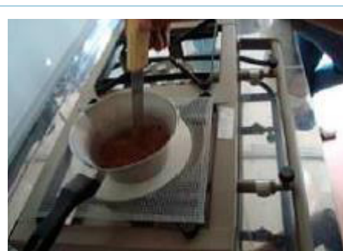
Figura 20 – Ensaio teor de umidade utilizando o fogareiro
