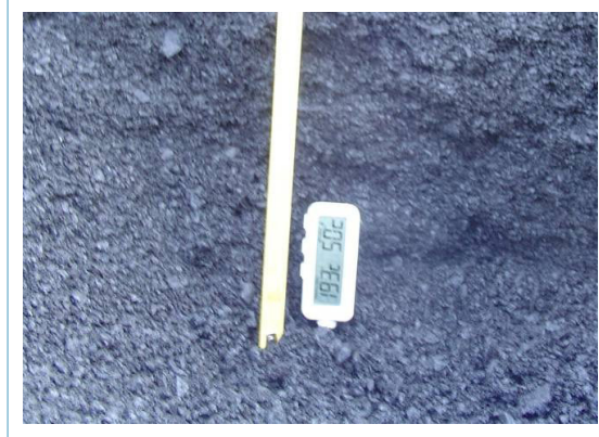
Foto 2 - Temperatura muito alta observada (193°C)
