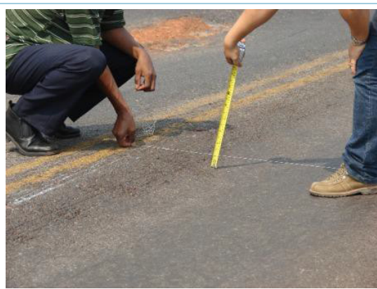
Foto 3 - Aferição da amplitude do afundamento
