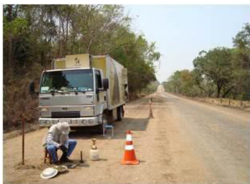
Figura 21 – Realização ensaio massa específica com emprego do frasco de areia
