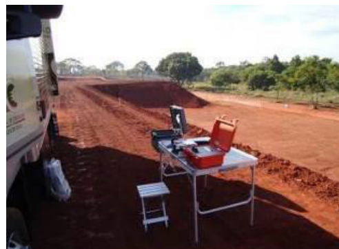
Figura 22 – Densímetro não nuclear utilizado em campo
