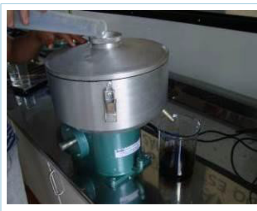
Figura 27 – Aparelho Rotarex para extração de asfalto
